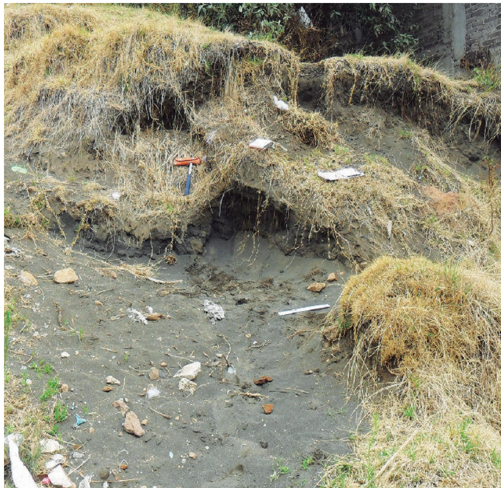
Figura 5.29. Fotografía B en el polígono de vulnerabilidad. Marcas de reptación con presencia de pastos que retienen el material en la ladera ya que las raíces fijan la superficie propiciando la formación de suelos. A pesar de la vegetación primaria, el fenómeno sigue activo (19.0811° N, 99.1355° W. Calle: 4ta de Morelos).
