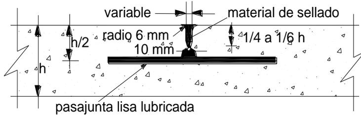
a.- Junta de contracción con ranuración para desarrollo ulterior de grieta
