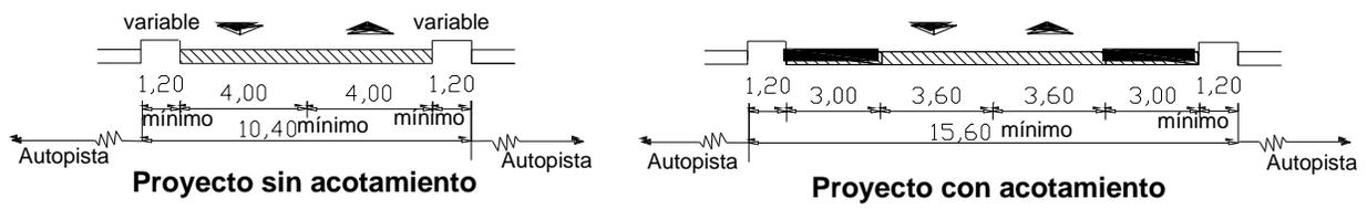
FIGURA 1 Secciones típicas para flujo normal en calzadas exclusivas para autobuses
