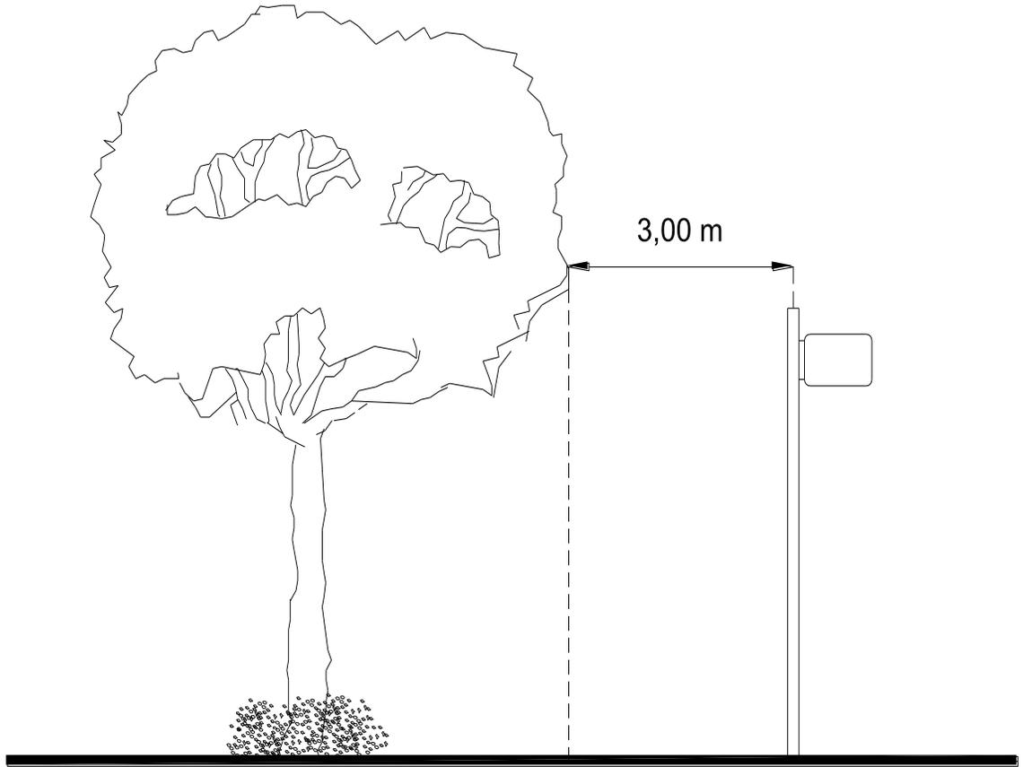
FIGURA 34. Distancia de separación de árboles a señalización vial y nomenclatura de calles.
