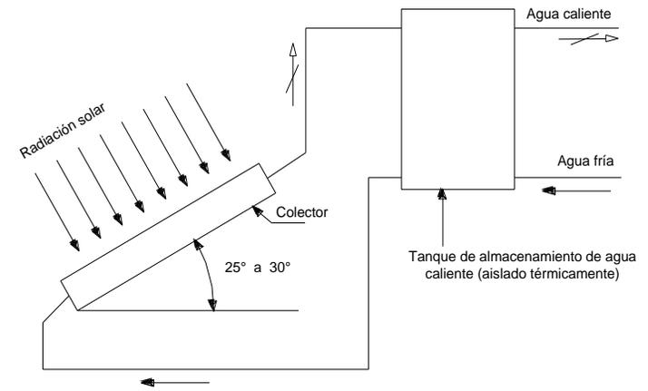
Sistema de calentamiento de agua por convección natural (termosifón)
