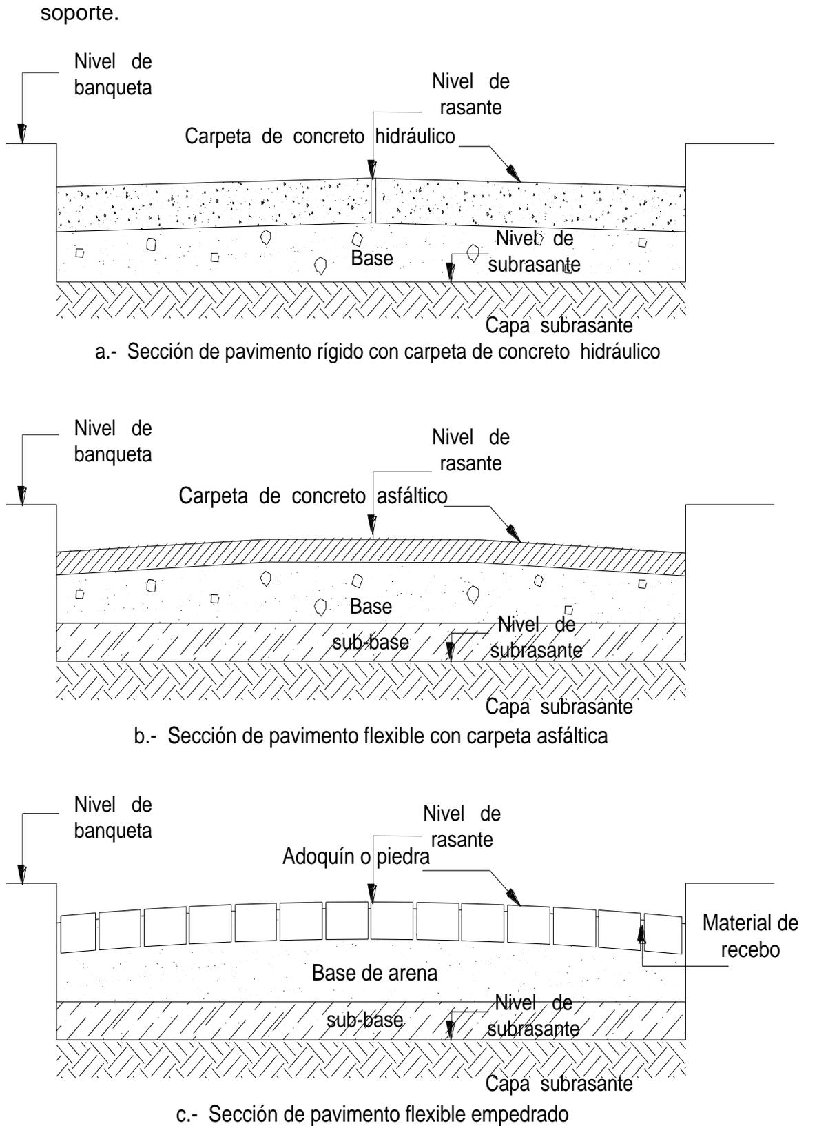
FIGURA 1 Secciones transversales de pavimentos
