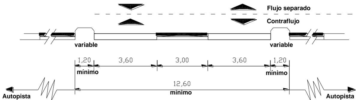
FIGURA 2 Secciones típicas para flujo separado y contraflujo en calzadas exclusivas para autobuses.
