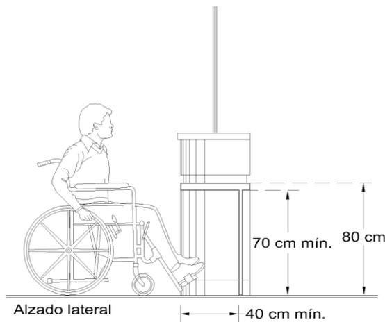
FIGURA 5 Dimensionamiento en módulos de atención al público
