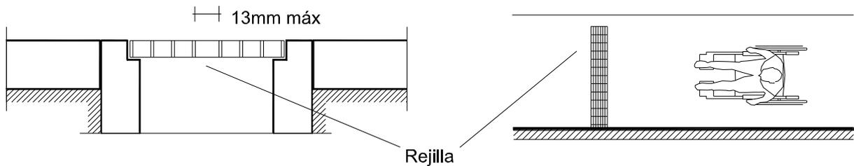
FIGURA 15 Detalles de barras y rejillas en pisos
