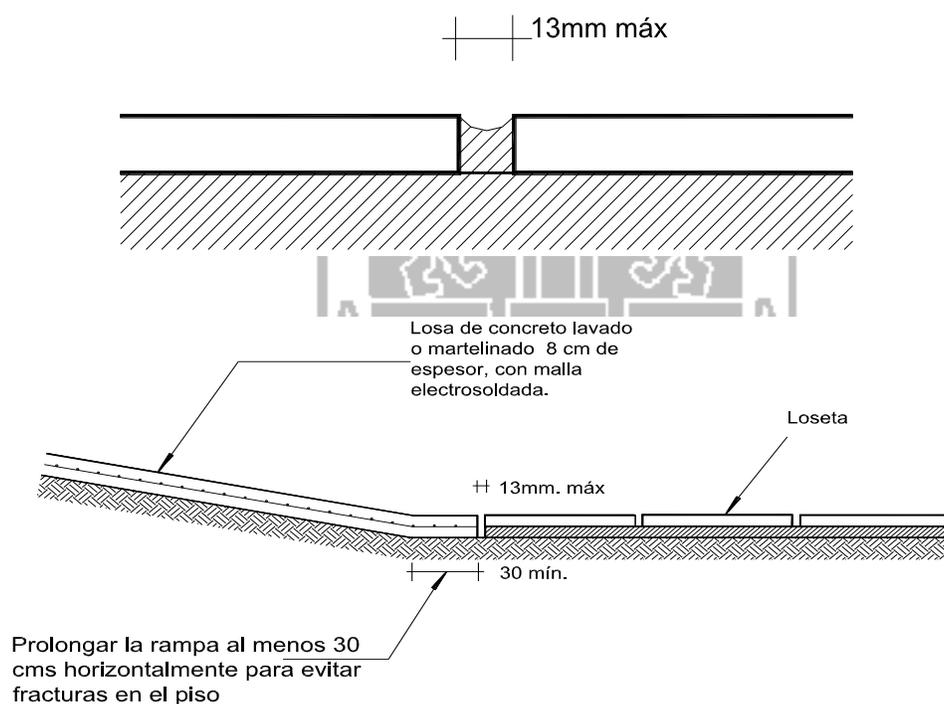
FIGURA 8. Detalles en pisos
