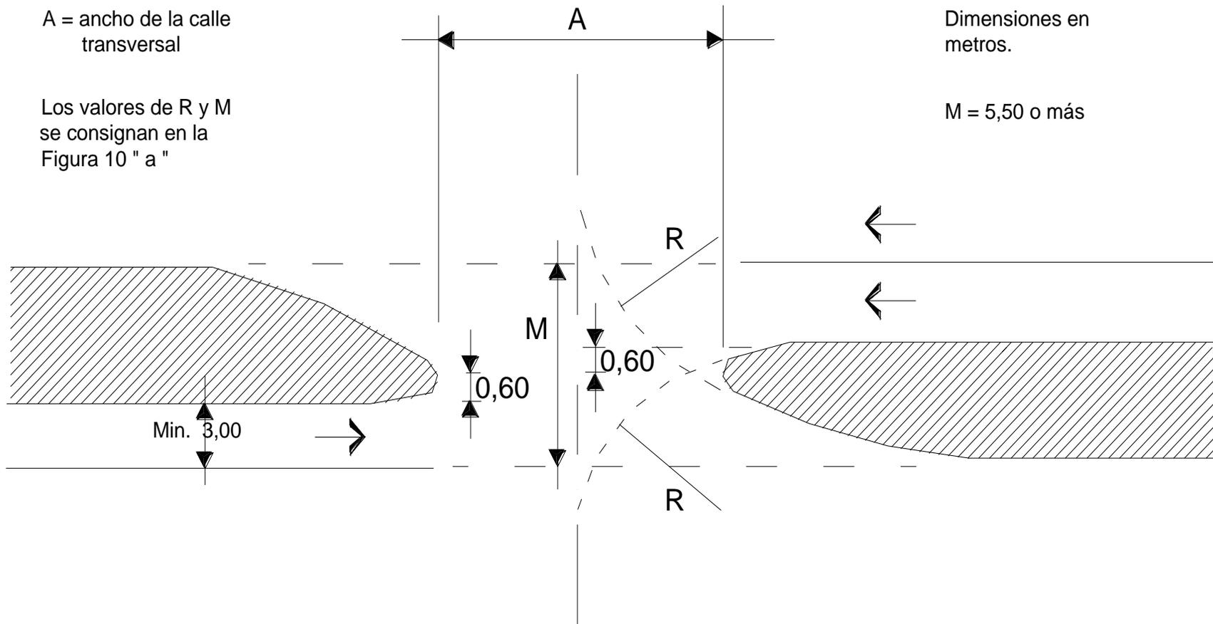
FIGURA 10 b Diseño de carril en la faja separadora central
