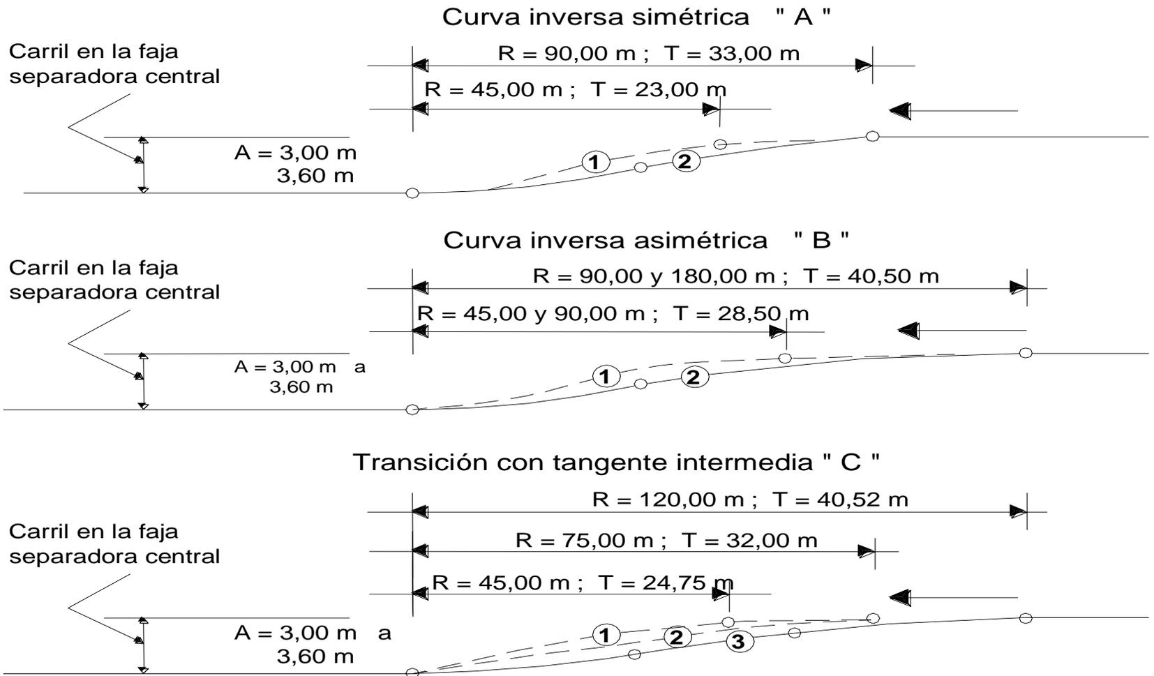
FIGURA 9 Transición del carril en la faja separadora central.
