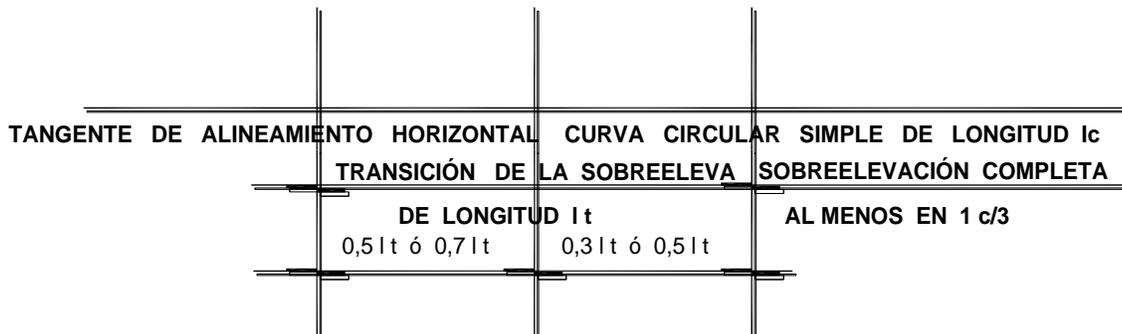
FIGURA 4a Transición de la sección en tangente a la sección en curva girando sobre una orilla de la corona.
