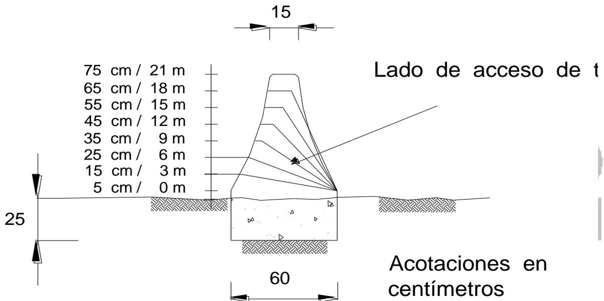
FIGURA 7 Barrera central de concreto.
