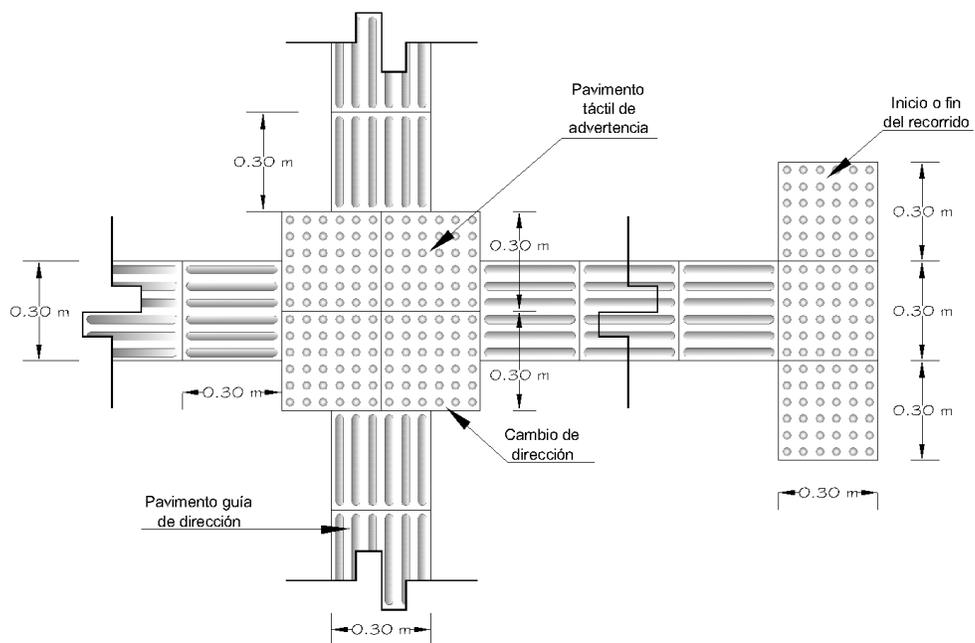
FIGURA 12 Cambios de dirección a 90° con módulos de advertencia
