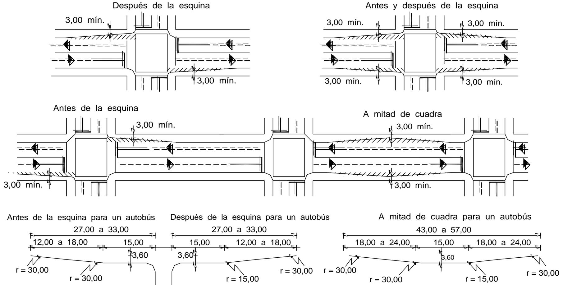
FIGURA 6 Diseño mínimo para paradas de autobuses (áreas de transferencia).
